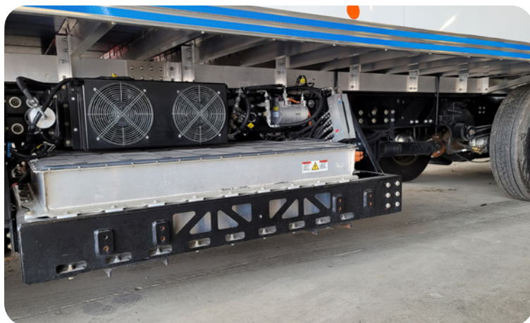
Détail de la sous-structure en aluminium d'un fourgon sec ultra léger
