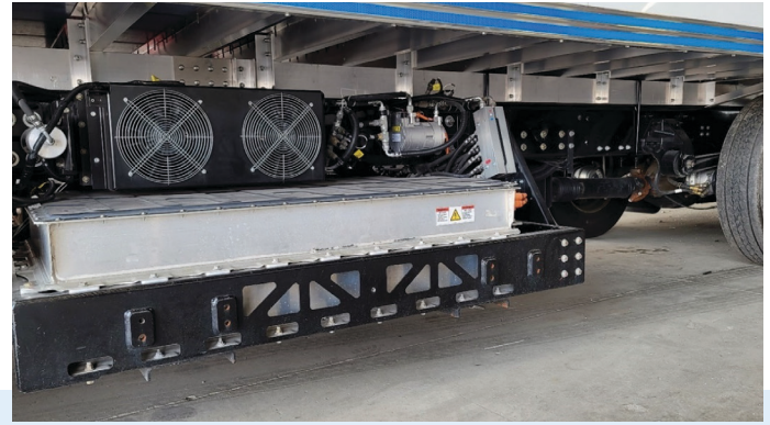
Détail de la sous-structure en aluminium d'un fourgon sec ultra léger
